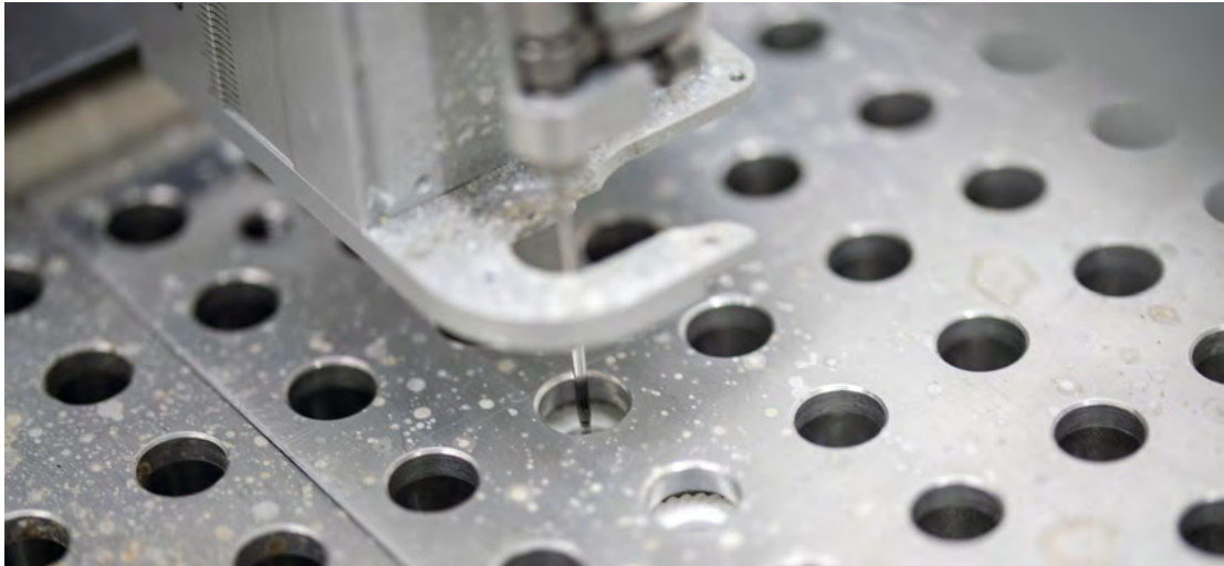
Probenwechsler des Karbonatmesssystems, der sowohl Säure zuführt als auch das CO 2 dem Massenspektrometer übergibt. Foto: T. Schwerdt
