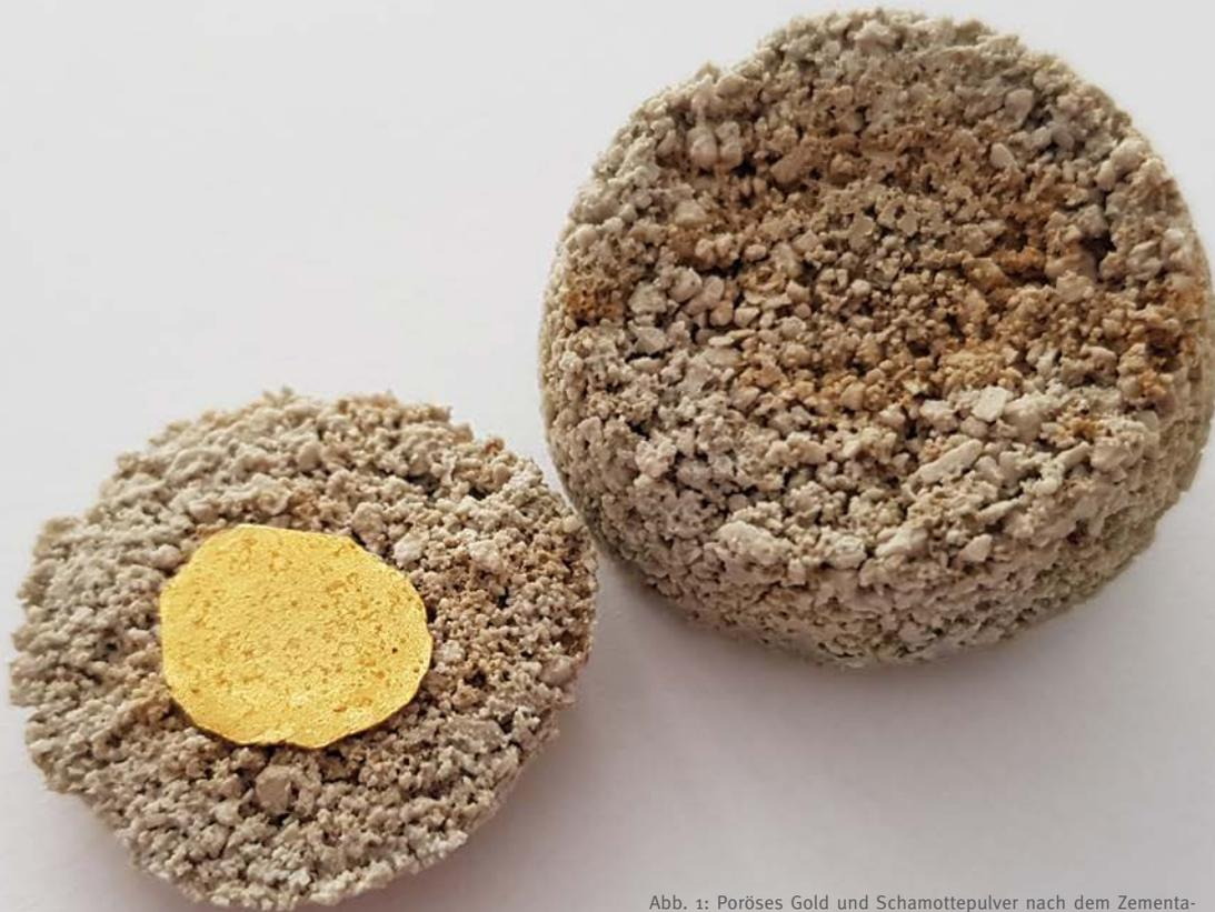
Abb. 1: Poröses Gold und Schamottepulver nach dem Zementationsexperiment (Foto: D. Berger, CEZA).
