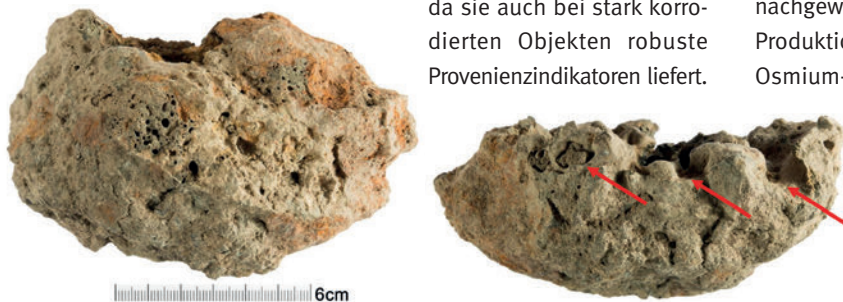
Schlackenkuchen aus Tel Hamid mit eingeschlossenen Düsen (rote Pfeile). Bildquelle: Y. Pagelson
