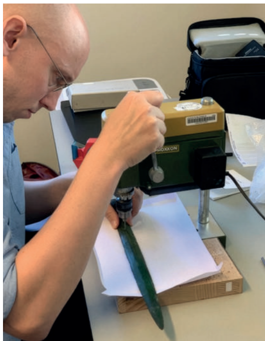
Bart Cornelis beim Beprobieren einer Schwertklinge mit einer kleinen Standbohrmaschine, die an der CEZA standardmäßig zum Einsatz kommt.
