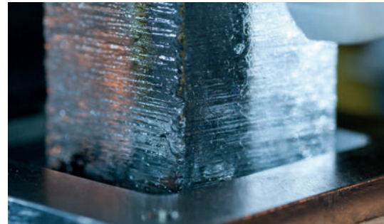
Eine Eisprobe auf dem Schmelzgerät während der kontinuierlichen chemischen Analyse von Eiskernen im Labor (Foto: Sylvain Masclin)
