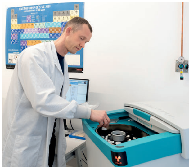
Voranalyse von Torfproben mittels EDRFA an der CEZA (Foto: T. Schwerdt).
