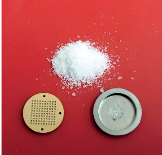
Abb 2: Vergleich Probenmengen Single Grain Scheibchen, SG (links), und Single Aliquot Regenerative, SAR (rechts) für die OSL Messung, hier am Beispiel von Quarzkörnern der Korngröße 100 – 200 µm
